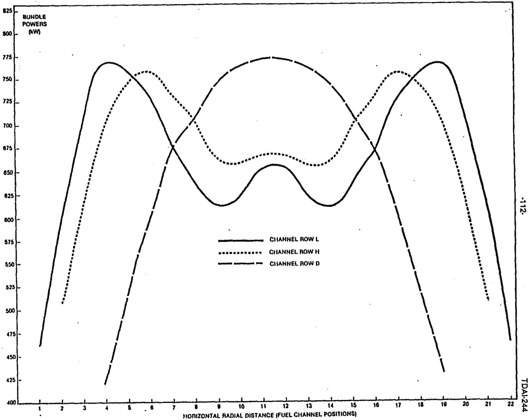
FIGURE 4.34 VERTICAL RADIAL BUNDLE POWER DISTRIBUTION AT 0 FPD
